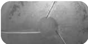
Tangentialschlitze der Düse in Makroaufnahme mit Clean up
