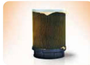
Diesel-Kraftstofffilter ohne Premium-Diesel ecoDrive nach 50.000 km
